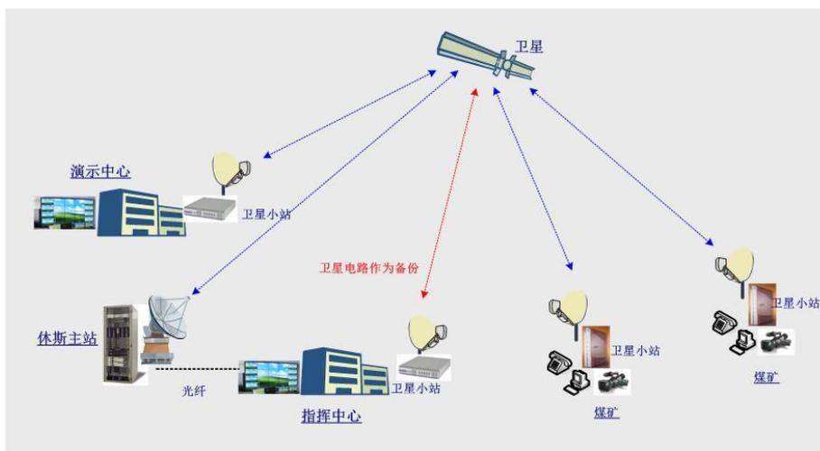
“煤矿安全生产卫星网络‘三网合一’远程实时监管系统”是休斯融合国内专业的矿业安监信息化团队，依托先进的卫星通信系统而开发的，可以提前发现、排除煤矿生产过程中的不安全隐患，有效解决安全生产监管工作中的瓶颈问题，变被动式管理为实时的主动管理，从而减少、避免安全事故的发生。
